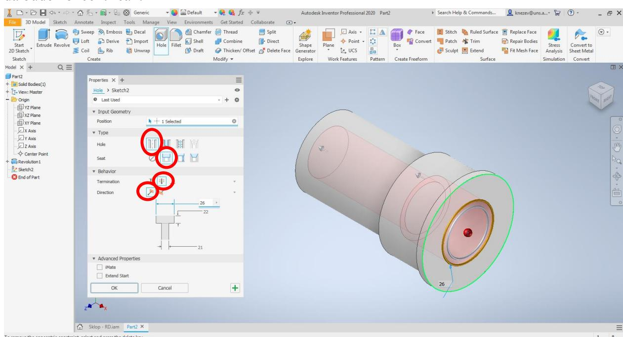
Slika 15. Bušenje otvora pomoću naredbe **Hole**
