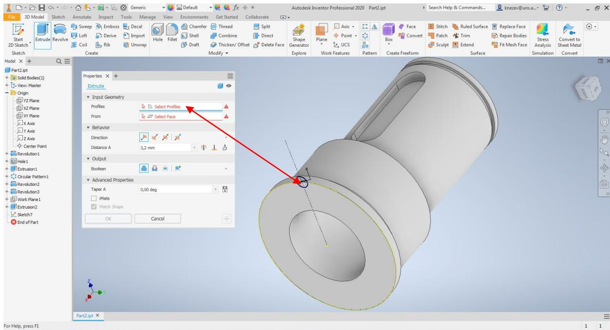
Slika 41. Označavanje profila za izvlačenje
