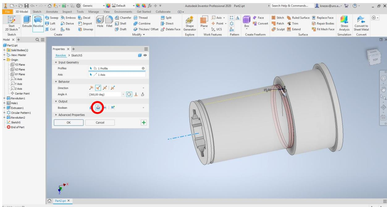
Slika 30. Rotacija profila žleba za izlaz strugarskog noža
