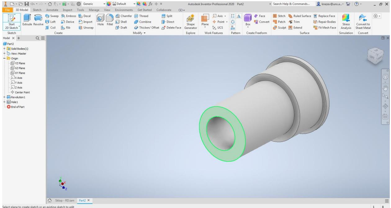
Slika 16. Površine skiciranja profila za izvlačenje žleba
