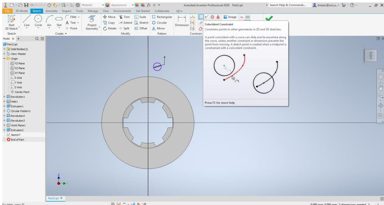
Slika 40. Ograničenje **Coincident Constraint**, skica kružnice i pomoćna vertikalna linija
