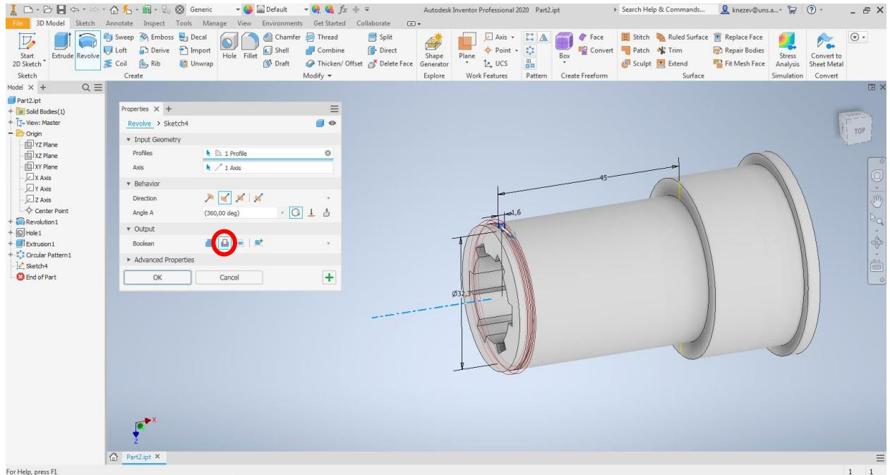
Slika 26. Rotacija profila žleba za uskočnik
