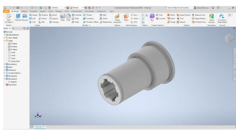
Slika 32. Izgled modela nakon modelovanja oba žleba za izlaz strugarskog noža
