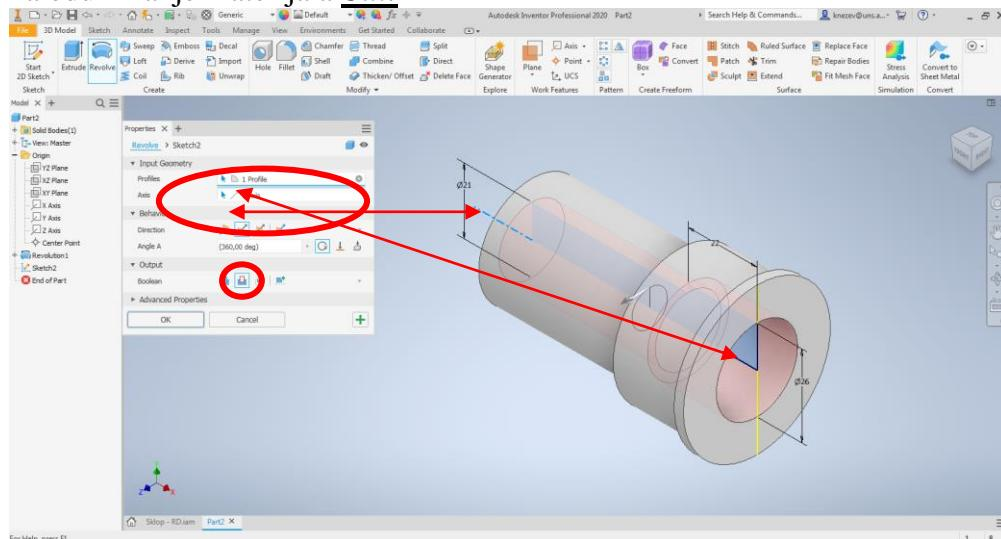
Slika 13. Rotacija profila za bušenje otvora sa cilindričnim upustom
