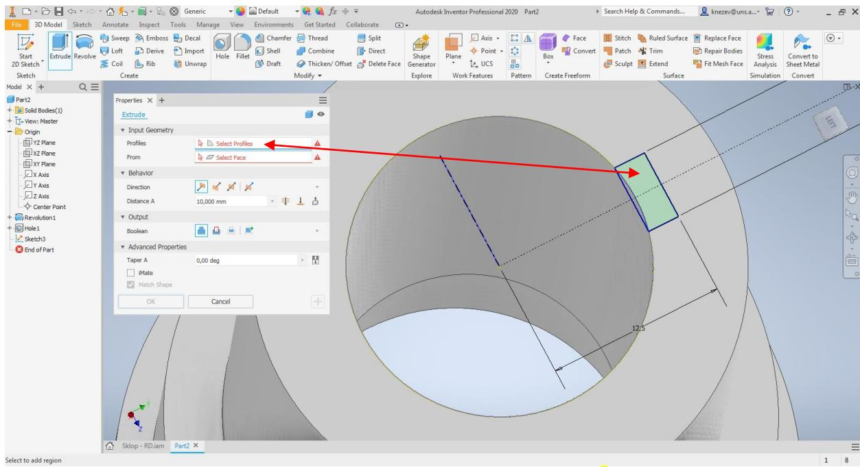
Slika 22. Označavanje profila za izvlačenje žleba
